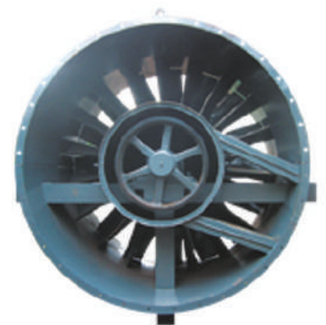
MAIN MINE VENTILATION FAN
