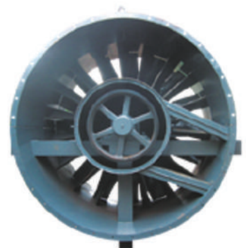
MAIN MINE VENTILATION FAN
